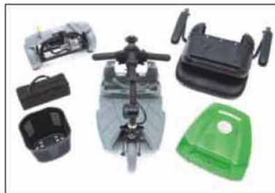
Εύκολη αποσυναρμολόγηση για μεταφορά στο πορτ-μπαγκάζ του αυτοκινήτου
